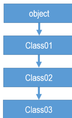
Рис. 4.1. Кілька пов'язаних через спадкування класів (а) та їх дерево ієрархії (б)
