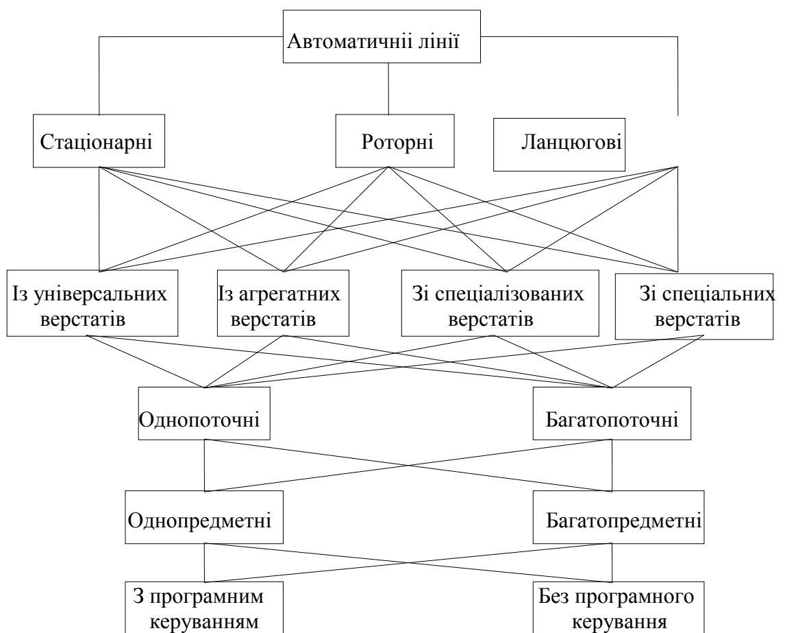
Рисунок 3.2. Варіанти автоматичних ліній
