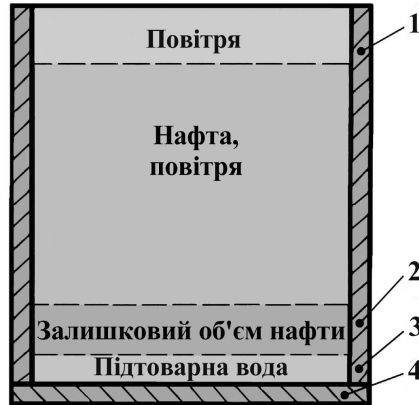
Рисунок 1. Схема вирізування зразків з різних ділянок (1, 2, 3, 4) нафтового резервуару після тривалої експлуатації
