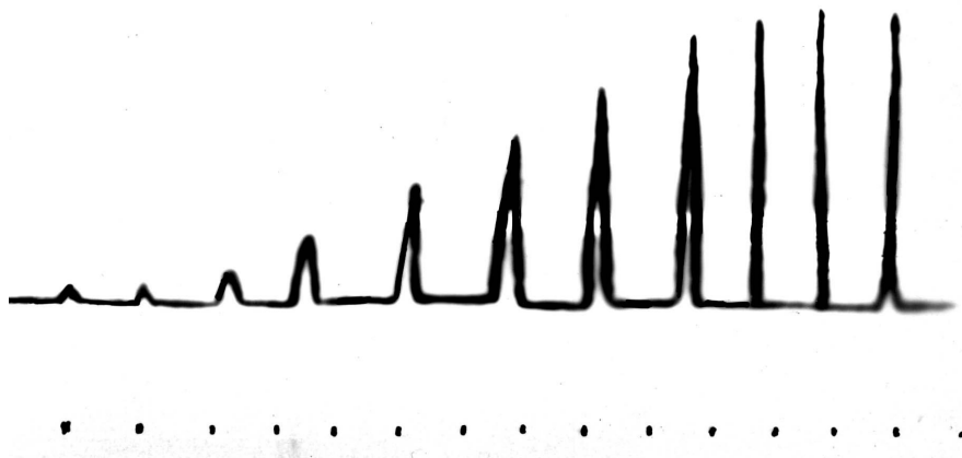
Рисунок 3 - Осцилограма експериментального дослідження процесу затягування різьбового з'єднання
