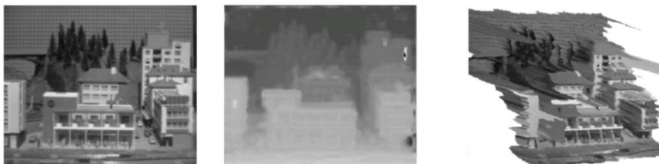
Рисунок 1 - Приклад побудови стерео моделі будівлі на основі кількох її зображень
