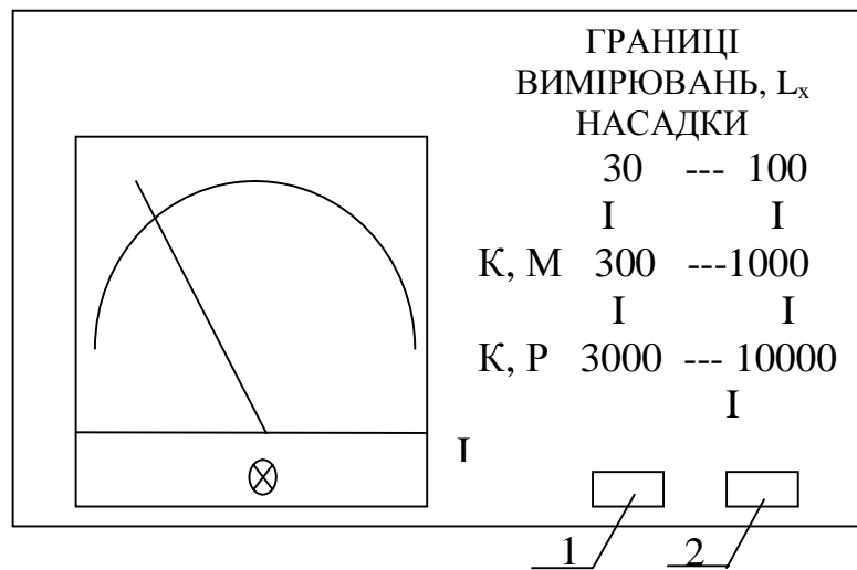
Рисунок 1.17 – Передня панель люксметра Ю-116
