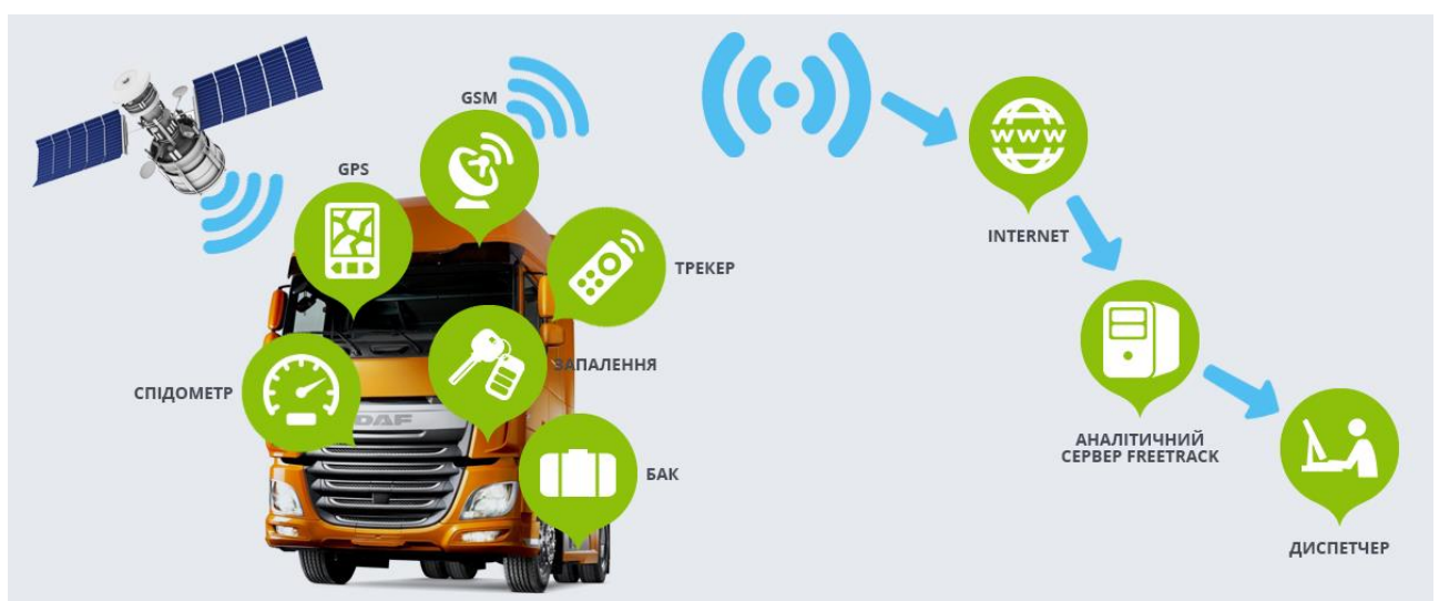
Рис. 1.3 – Схема функціонування системи керування за рухомих об'єктів на карті з використанням програмно-апаратних рішень
