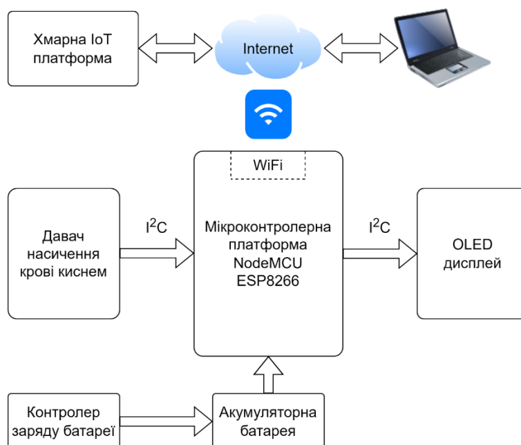
Рисунок 1. Структура системи моніторингу насиченості киснем крові на основі ІоМТ
