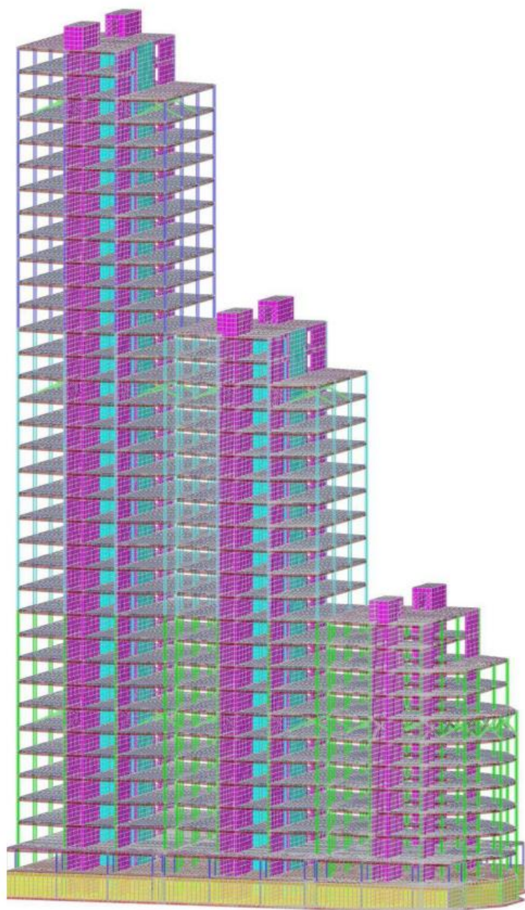
Рисунок 2.1 - Модель каркаса будівлі
