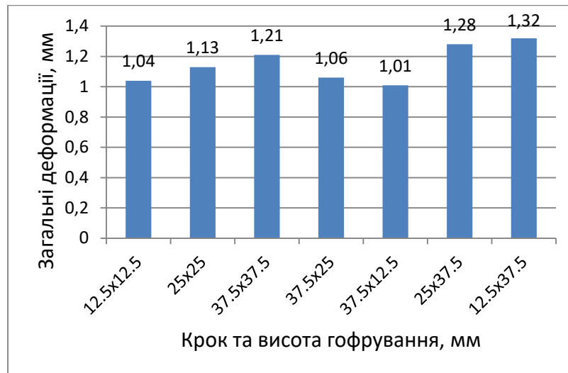
Рисунок 3.23 – Графік залежності загальних деформацій від геометричних параметрів хвилястого гофрування
