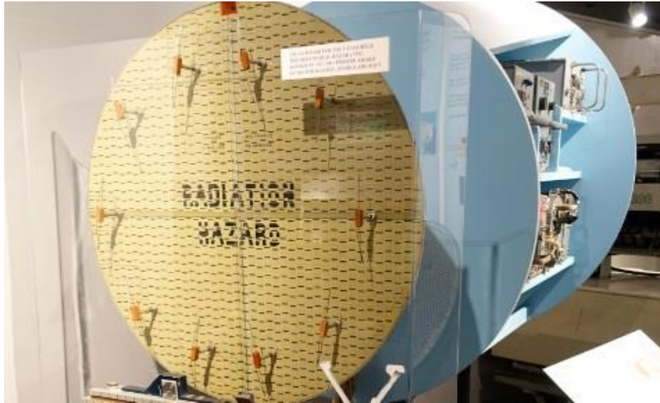
Рис. 1.32. Зовнішній вигляд щілинної антени
