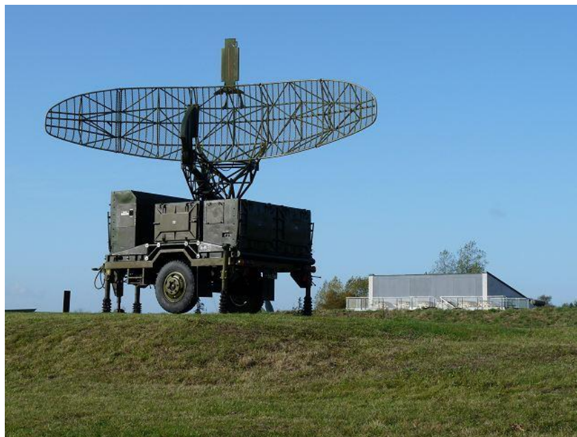
Рис. 1.17. Зовнішній вигляд параболічної антени
