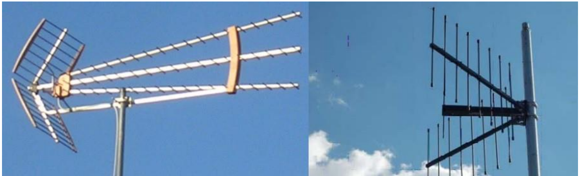
Рис. 1.6. Зовнішній вигляд кутникової антени
