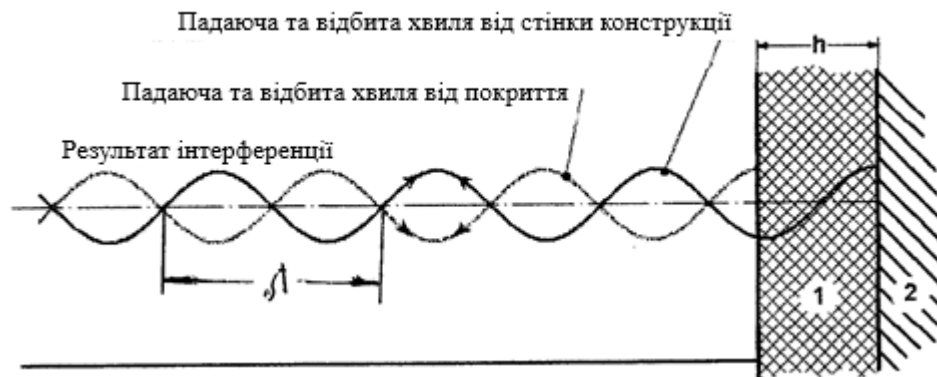
Рис. 2.3 Принцип роботи інтерференційного вузькодіапазонного матеріалу: 1 – шар діелектрика 2 – стінка конструкції.
