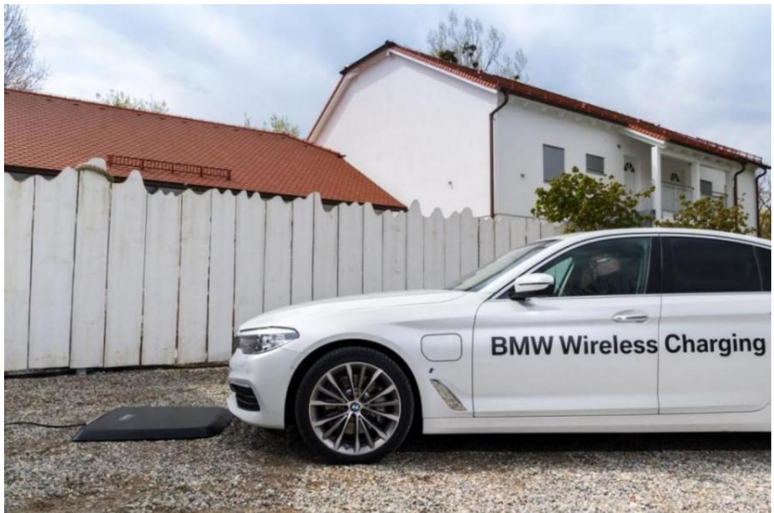
Рис. 1.3. Тестування бездротового зарядного пристрою з електромобілем BMW [9]
