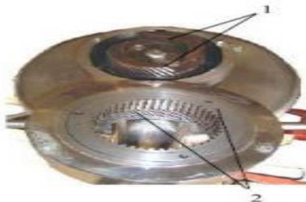
Рис. 1.9. Колоїдний млин: 1 – ротор; 2 – статор
