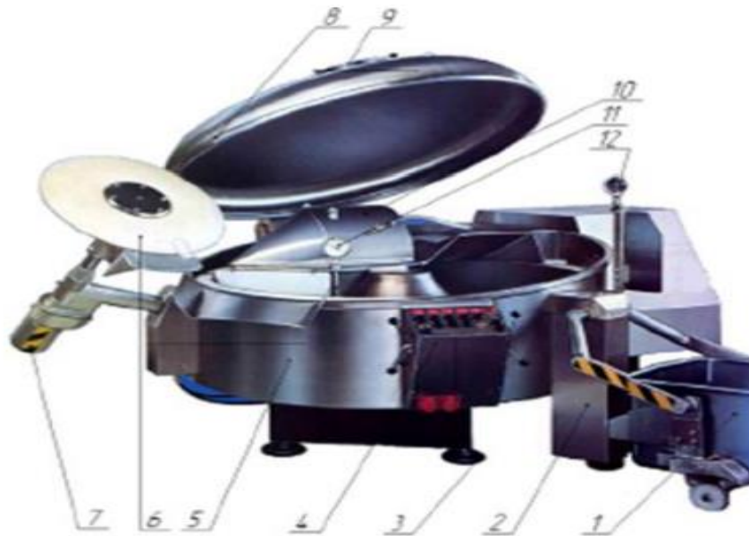
Рис. 1.3. Вид закритого кутера: 1 – візок ; 2 – завантажувальний пристрій; 3 – ніжки; 4 – керувальний пульт; 5 – станина; 6 – диск вивантаження; 7 – двигун диску; 8 – кришка вакууму; 9 – вікно для огляду; 10 – мала кришка; 11 – термометр; 12 – таймер
