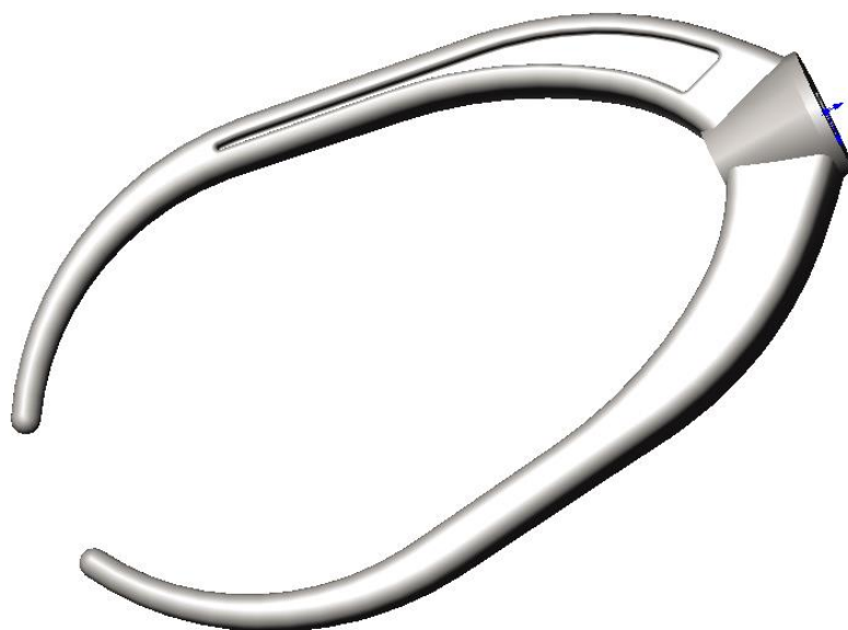
Рис. 4.1. Конструктивна схема місильного органу тістомісильної машини МТ-200.
