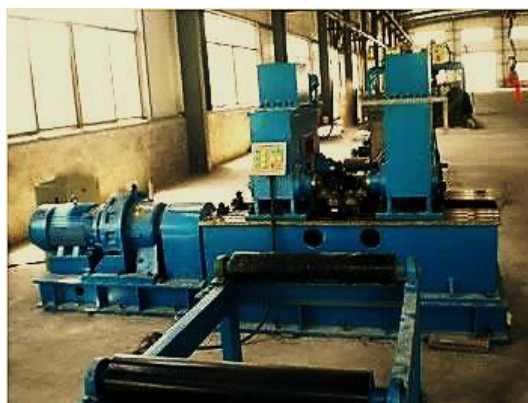
Рис. 3.15 Установка для виправлення зварних балок типу УТJ-60В [14]
