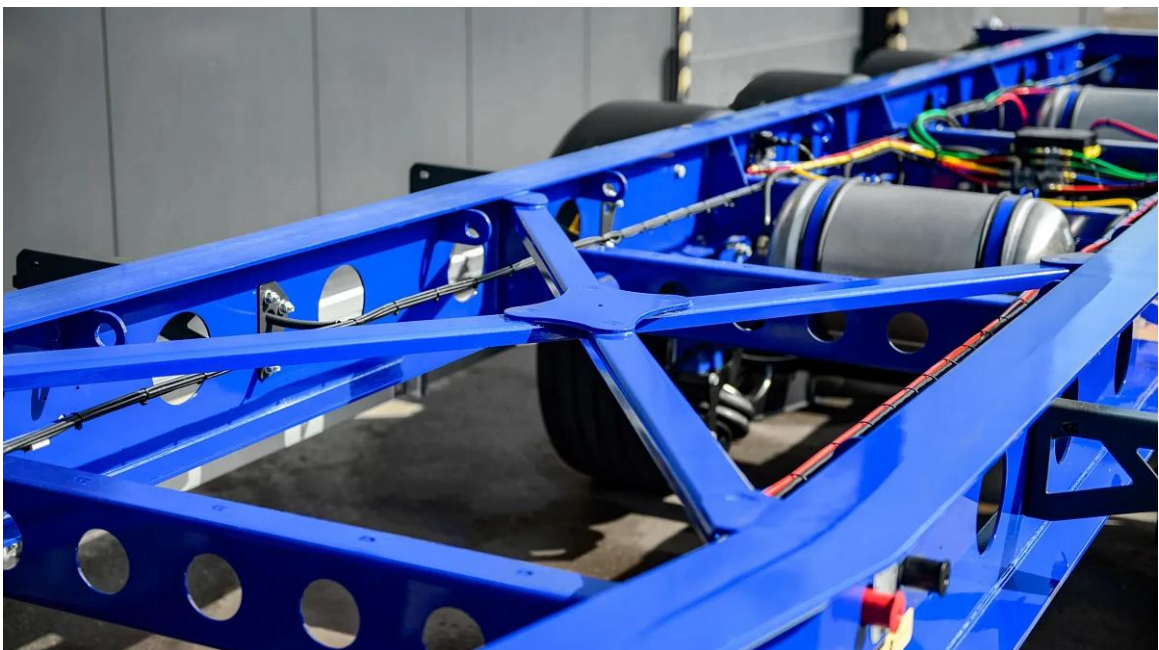
Рис. 1.5. Рамна конструкція з круглими отворами в лонжеронах та поперечках
