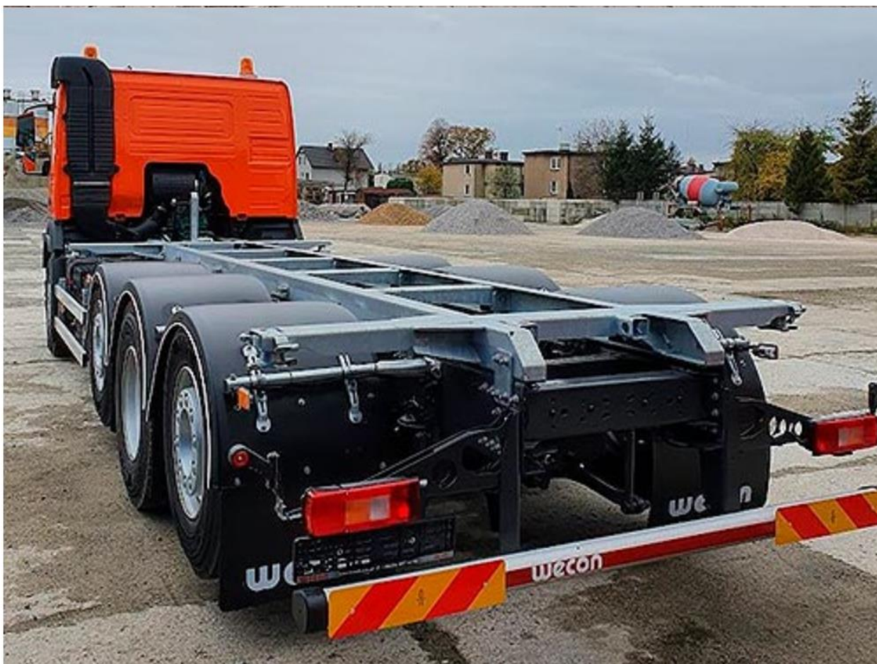
Рис. 1.2. Рама контейнеровоза з суцільними стінками лонжеронів
