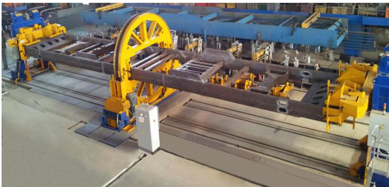
Рис. 4.3. Загальний вигляд зварювального кантувача [14]
