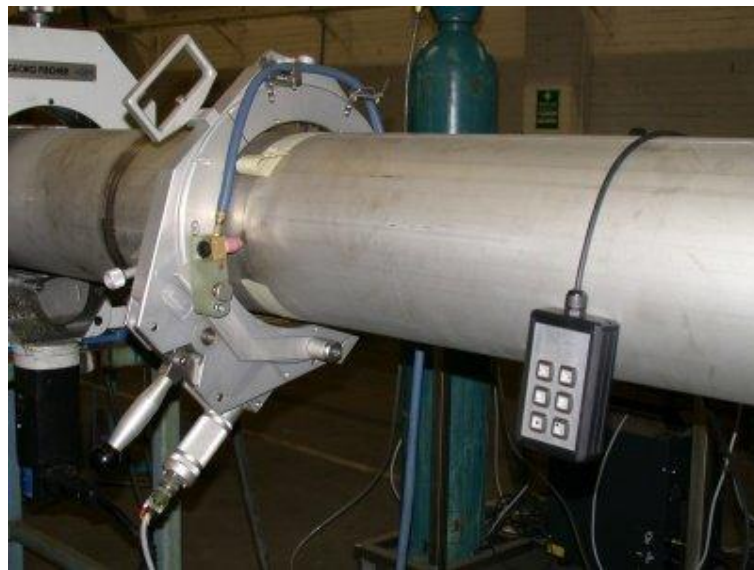
Рис. 3.4 Процес автоматичного аргано-дугового зварювання
