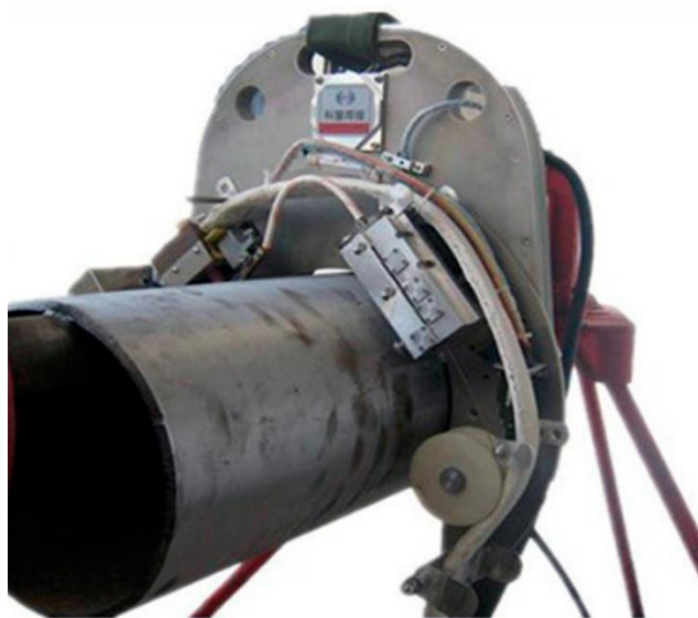
Рис. 3.14 - Процес автоматичного орбітального зварювання
