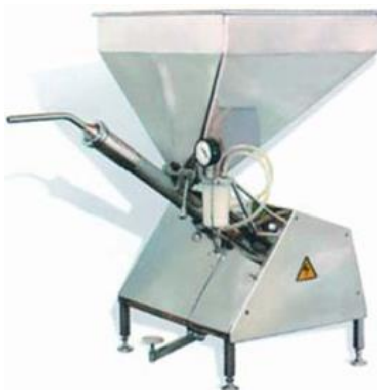
Рис. 1.7. Одноцівковий шприц ЯЗ-ФША
