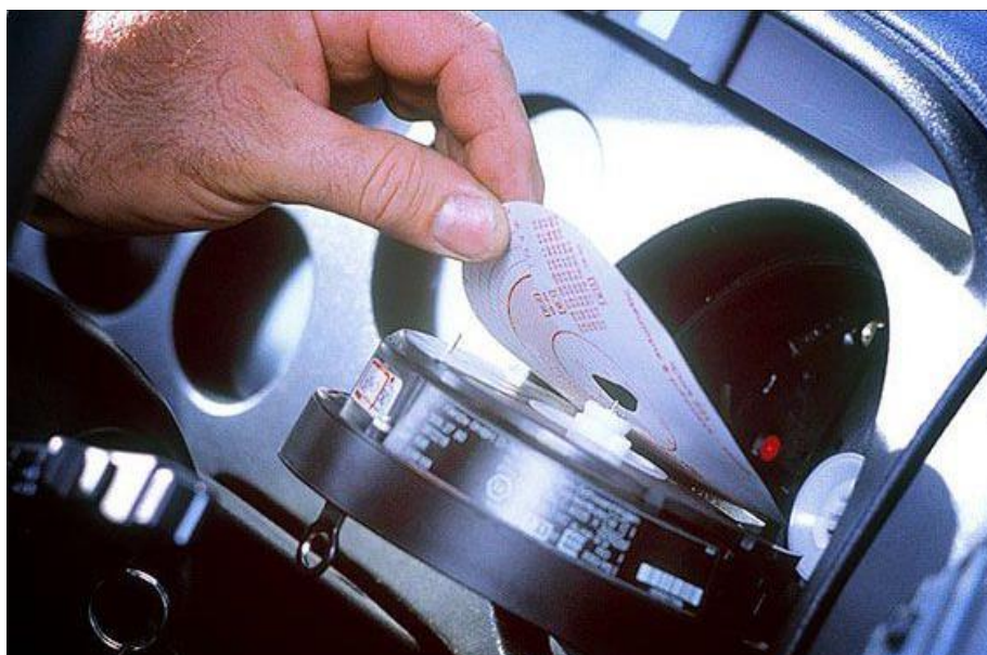
Рисунок 3.2 – Встановлення тахокарти в аналоговий тахограф
