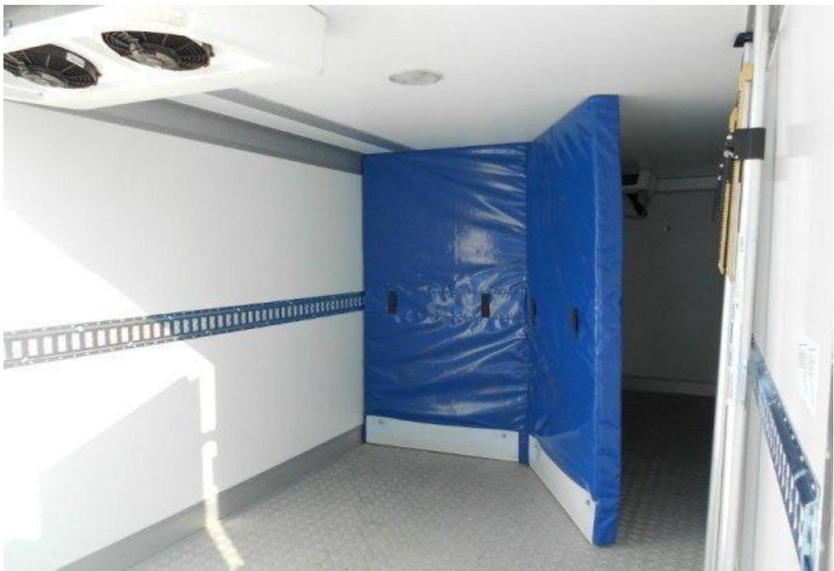
Рисунок 3.2 – Термоізоляційна перегородка у кузові рефрижератора
