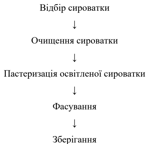
Рисунок 2.1. Загальні операції виготовлення напою з сироватки
