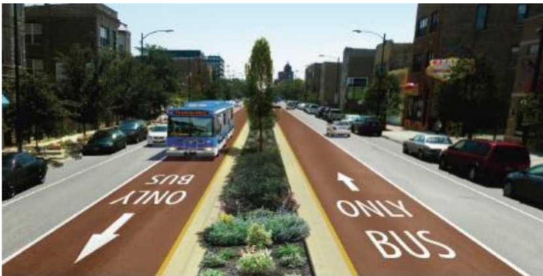
Малюнок 2.5 - Виділена смуга громадського транспорту, облаштована ліворуч дороги
