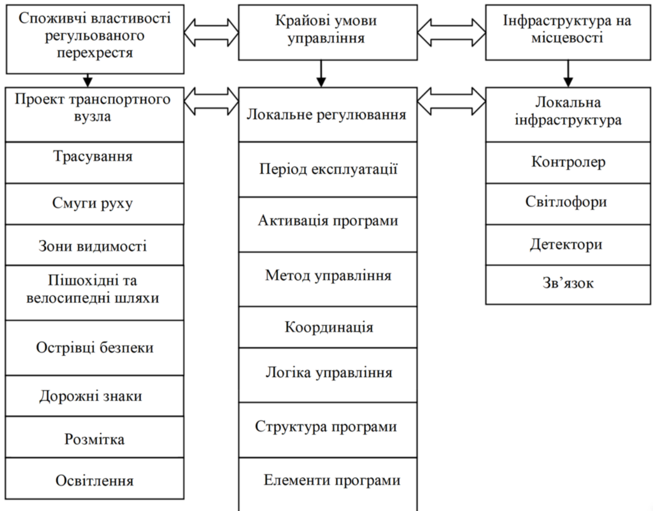
Малюнок 2.2 - Система керування дорожнім рухом за допомогою світлофорного регулювання
