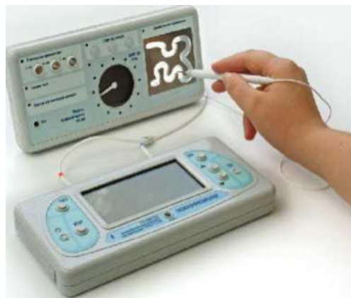
Рисунок 3.13 – Пристрій психофізіологічного тестування
