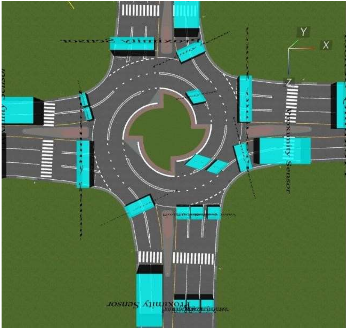
Рисунок 2.9 – Розташування датчиків наближення
