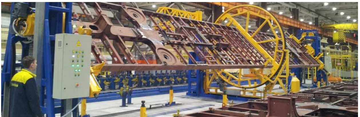
Рис. 3.2 – Технологічний процес роботи кантувача зварювального
