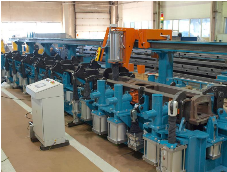
Рис. 3.3 – Складальний кондуктор для збору рами
