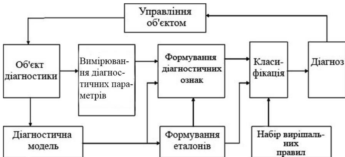
Рис. 2.8. Функціональна схема системи технічної діагностики стану вузлів легкових автомобілів
