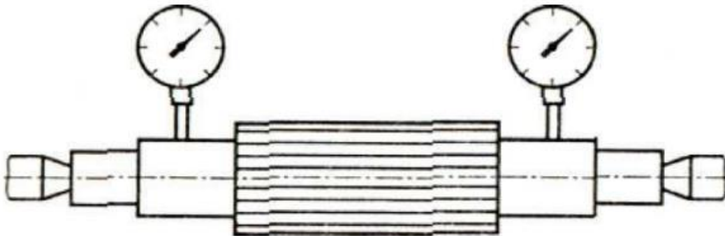
Рисунок 4.1 – Вимірювання не співвісності шийок валів
