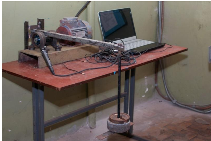
Рис. 3.2. Тривимірний вигляд системи навантаження та фіксації вузла кулькових підшипників (а) і лабораторний комплекс для акустичного тестування роликів підшипників (б).
