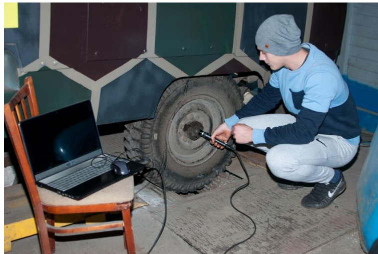
Рис. 3.3. Аналіз звукових характеристик підшипників за допомогою випробувального обладнання для вивчення тягових та динамічних властивостей автотранспорту.
