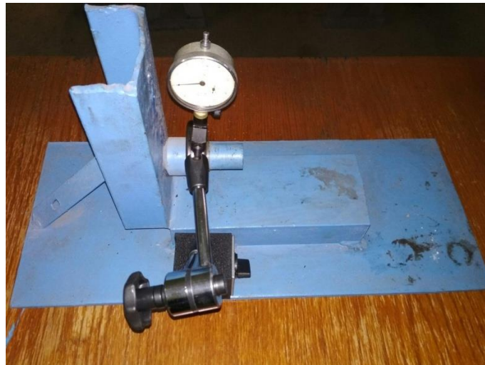
Рис. 4.2. Лабораторне обладнання для визначення радіального відхилення підшипників.
