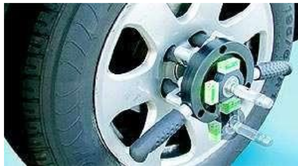
Рис. 3.12. Обладнання для вимірювання геометрії підвіски автомобіля.
