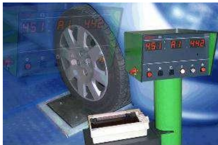
Рис. 3.14. Обладнання для оцінки фрикційного коефіцієнта між колесом та поверхнею дороги.
