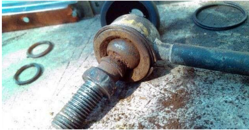
Рис. 2.9. Видалений захисний ковпачок амортизатора стабілізатора.
