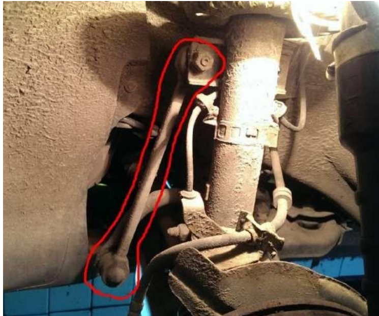
Рис. 1.4. Компоненти, що забезпечують стійкість на автомобілі, пов'язані з функціонуванням стабілізатора.
