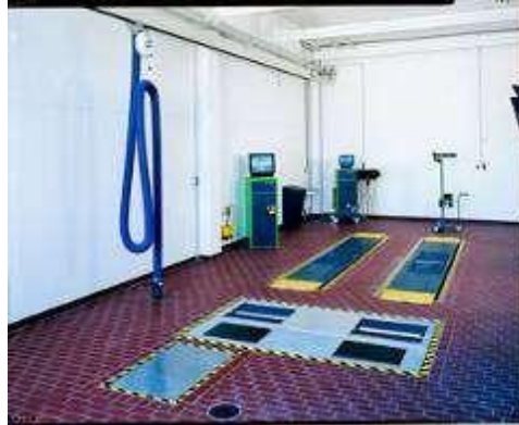
Рис. 3.10. Апаратура для перевірки підвіски автомобіля
