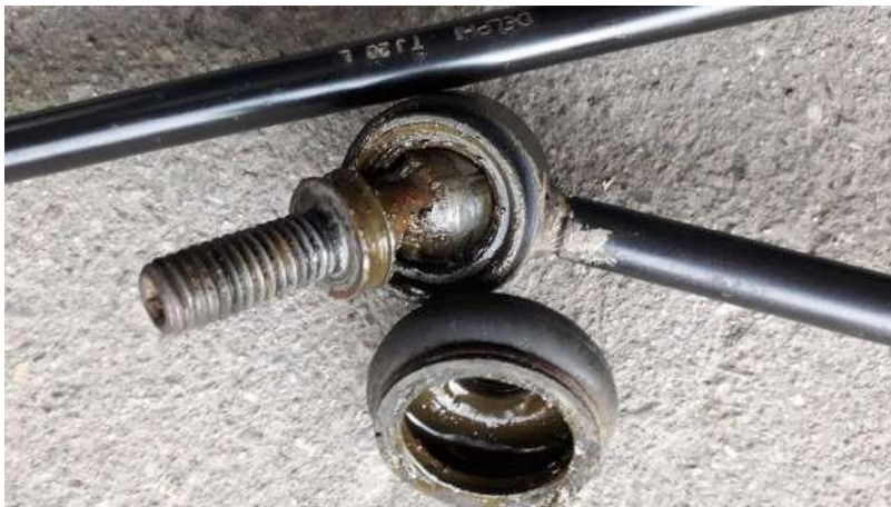
Рис. 2.6. Видалений захисний ковпачок тяги стабілізатора.
