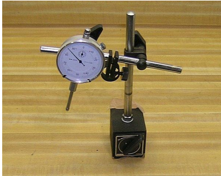
Рис. 4.3. Циферблатний індикатор з магнітним тримачем.
