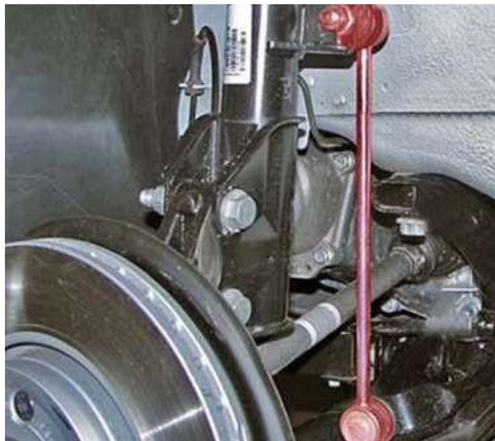
Рис. 2.2. Демонтаж стабілізуючого тяги.
