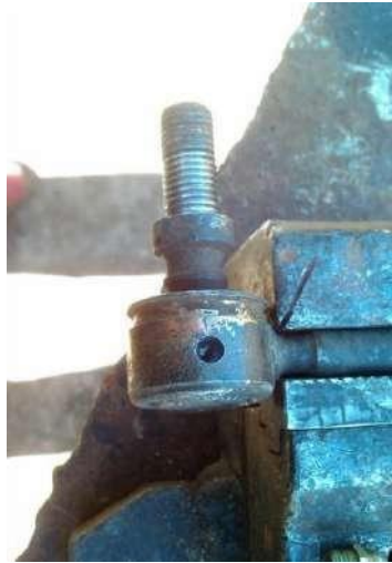
Рис. 2.12. Виконати свердління бокової частини шарніра.
