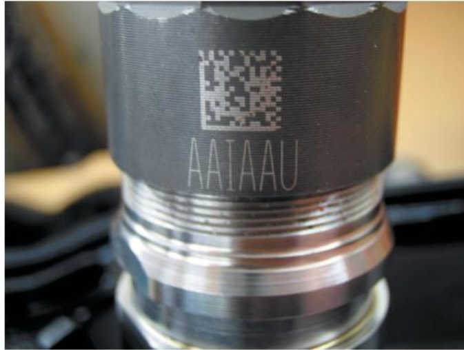
Рис. 2.4. Букви на боці цього інжектора на дизельному двигуні Cummins об'ємом 6.7 літра вказують на номер калібрування інжектора.
