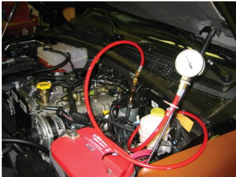
Рис. 2.1. Використання манометра для вимірювання тиску палива з підйомного насоса в 6.7-літровому дизельному двигуні Cummins.
