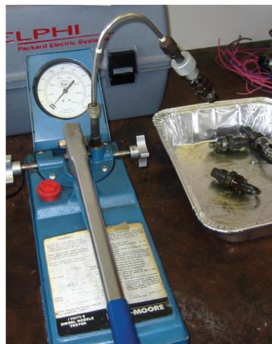
Рис. 2.3. Типовий пристрій для перевірки, який використовується для тестування візерунка розпилення форсунки дизельного двигуна.
