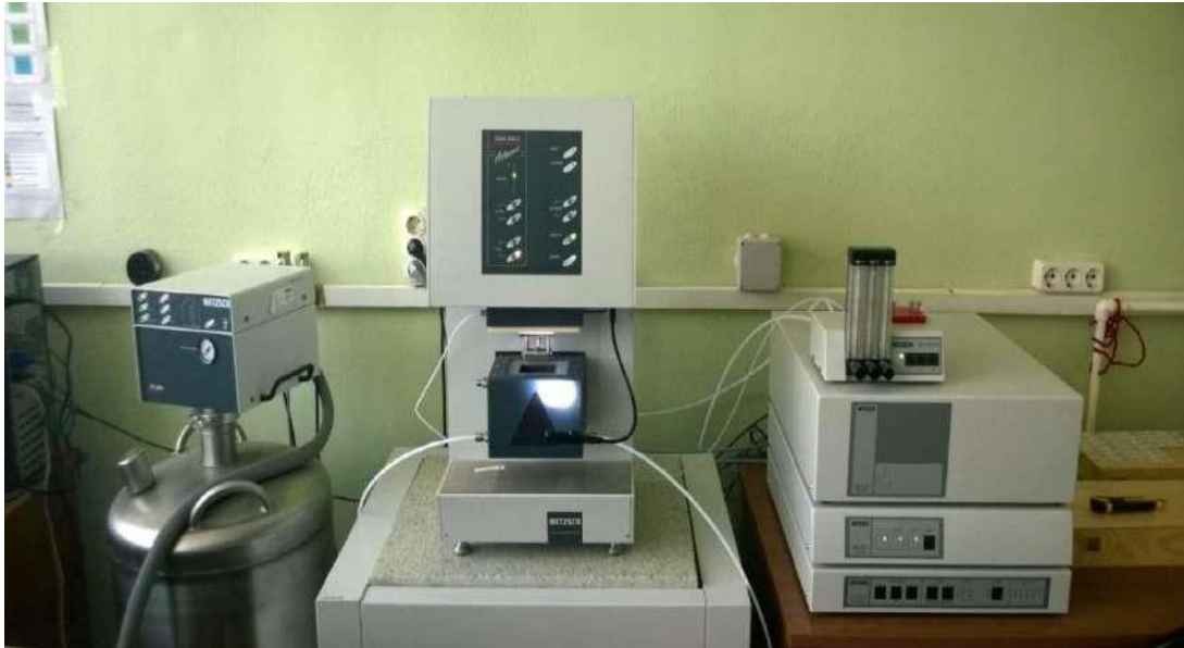
Рис. 3.5. Зовнішній вигляд пристрою DMA 242 E Artemis.
