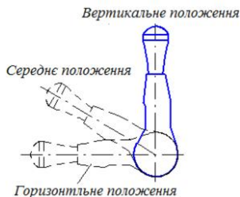
Рис. 1.2. Діаграма основних позицій важеля паркувального гальмового вентиля.
