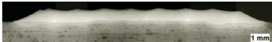
Рис. 2.17. Зображено перетин лазерно наплавленого круглого зразка
