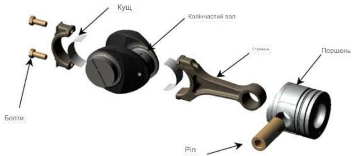
Рис. 3.2. Основні елементи колінчастого валу двигуна.
