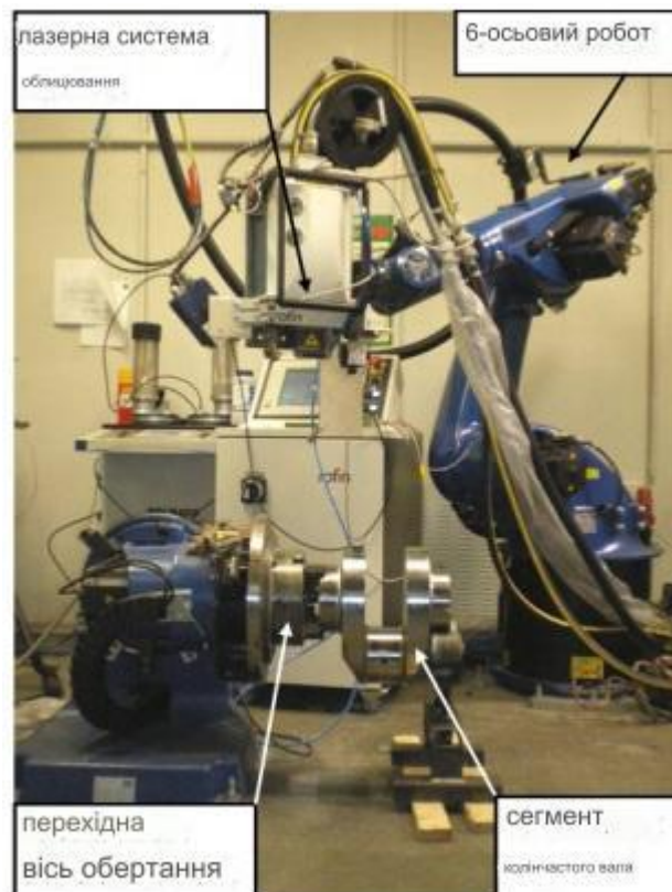
Рис. 2.11. Установка лазерної головки наплавлення на роботизовану систему маніпуляції, характеристики процесу наплавлення
