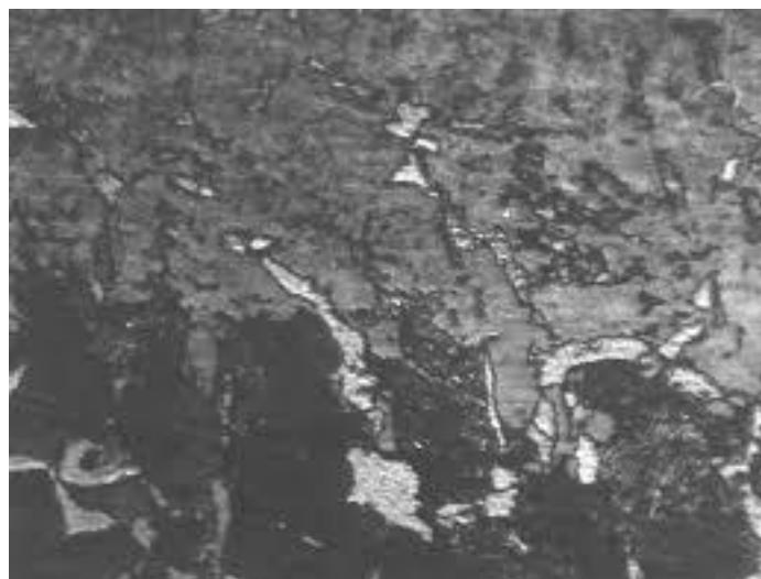
Рис. 4.14. Мікроструктура сталі після застосування лазерної термічної обробки
