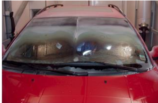
Рис. 3.5. Схема розморожування через 18 хвилин після початку експерименту.
