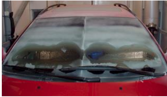
Рис. 3.4. Схема розморожування через 14 хвилин після початку експерименту.
