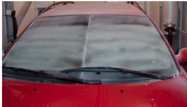
Рис. 3.2. Схема розморожування через 7 хвилин після початку експерименту.
