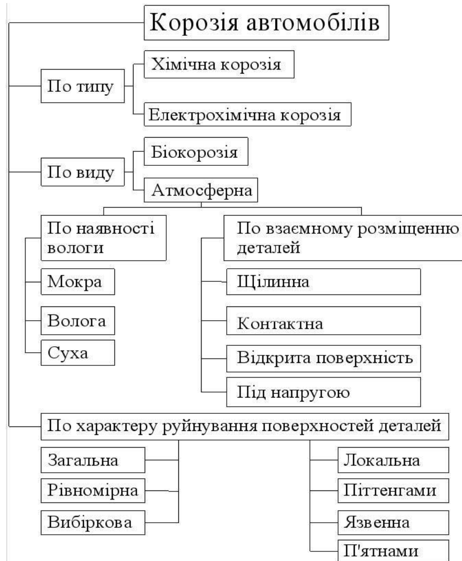
Рис. 1.5. Типологія корозійних процесів у транспортних засобах та обладнанні для введення добрив.
