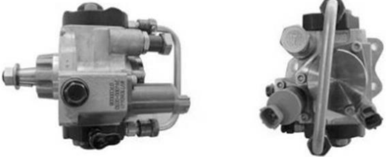
Рис. 2.11. Підкачуючий паливний насос Feed pump.
