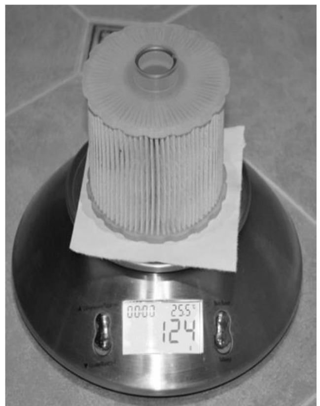
Рис. 2.13. Вага фільтра після заправки паливом та наступного висушування
