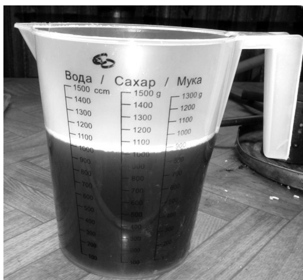
Рис. 4.15. Паливо, яке пройшло через абсолютно новий фільтра
