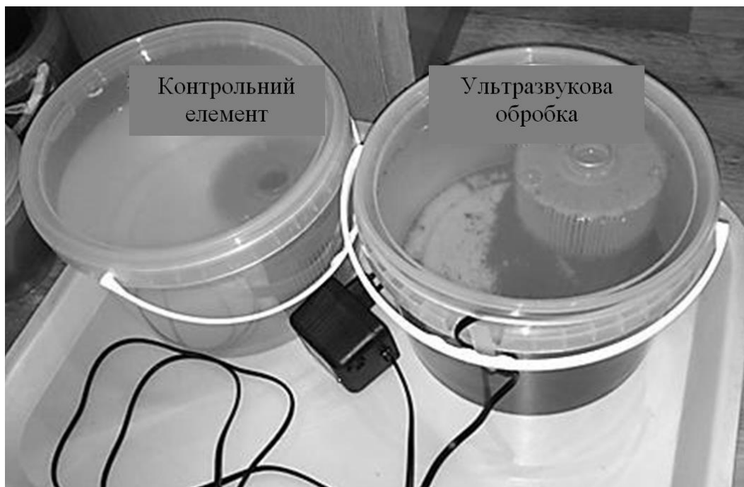
Рис. 4.13. Елементи фільтрації, занурені у резервуари з паливом.
