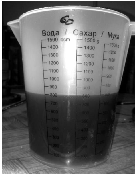
Рис. 4.17. Паливо, яке пройшло через фільтр з пробігом 14783 км
