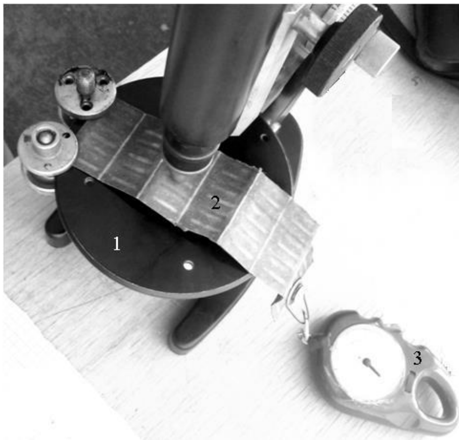
Рис. 2.9. Обладнання для оцінки еластичності мембрани в пристроях фільтрації: 1 - мікроскоп; 2 - мембрана фільтра, закріплена на столі мікроскопа; 3 - динамометр
