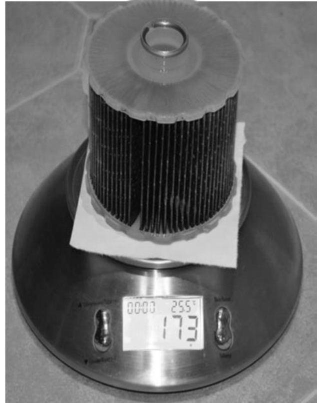
Рис. 2.15. Вага фільтра після використання на протязі 20 000 км
