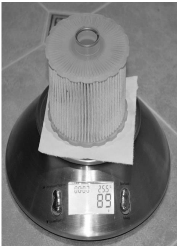
Рис. 2.12. Вага свіжого фільтра після виробництва
