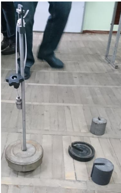
Рис. 4.7. Зображення процесу вимірювання сили розриву магнітного захвату.
