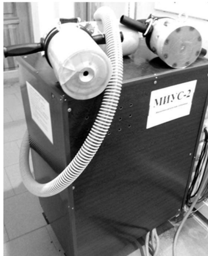
Рис. 3.5. Процес відновлення кузовних елементів з використанням магнітно-імпульсної техніки.
