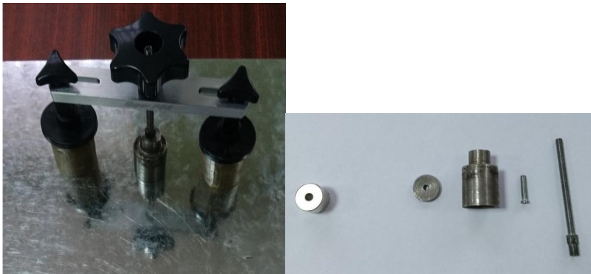
Рис. 3.9. Фото мініліфтеру із єдиним магнітним утримувачем
