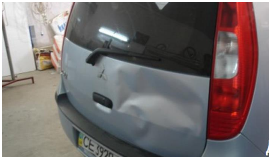
Рис. 4.9. Приклад пошкодження на кузові Mitsubishi Colt.
