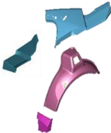
Рис. 2.40. Зовнішня підбірка колісної арки зі структури, з'єднаної точковим зварюванням.
