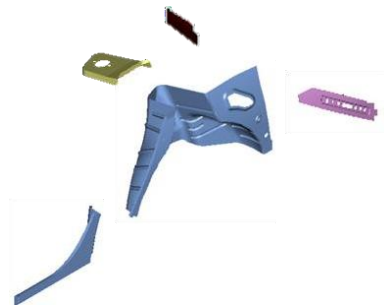
Рис.2.34. Внутрішня підборка колісної арки зі структури, з'єднаної точковими зварюваннями.
