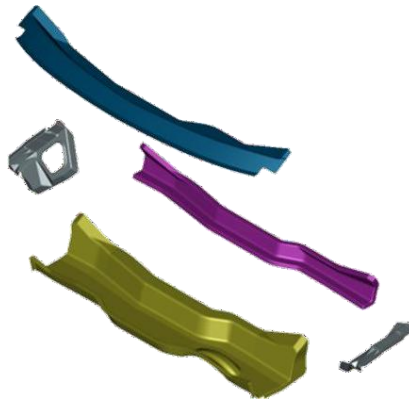
Рис. 2.26. Підвузол панелі капота конструкції з точковим зварюванням.
