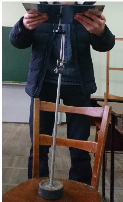
Рис. 4.8. Зображення процесу вимірювання сили розриву клеючого грибка.
