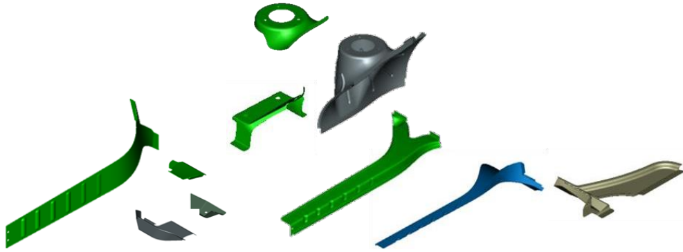
Рис. 2.27. Внутрішня (ліворуч) і зовнішня (праворуч) передня рейка конструкції зварної конструкції
