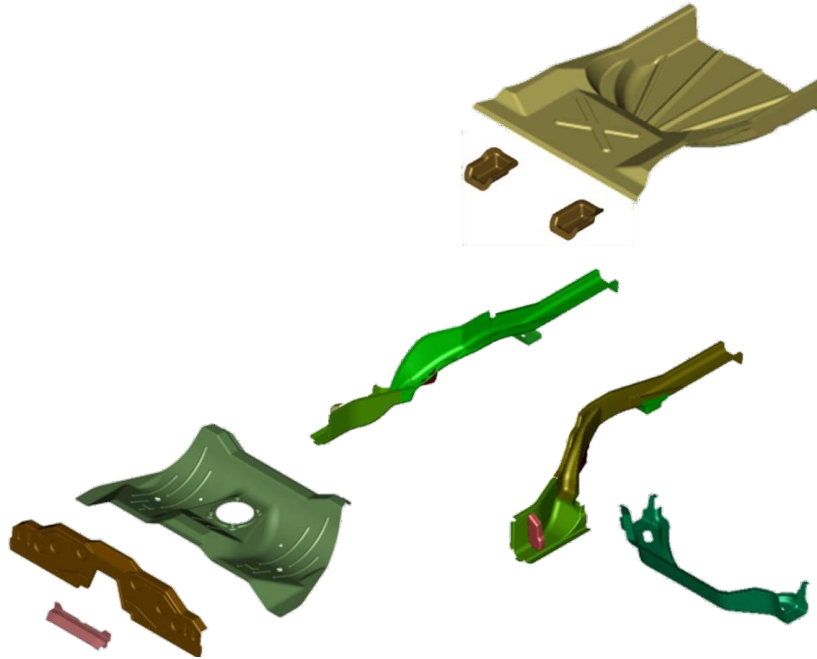
Рис. 2.33. Деталі для монтажу до задньої частини підлоги.
