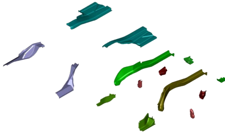
Рис. 2.32. Задня направляюча підсекція конструкції, з'єднана точковим зварюванням.
