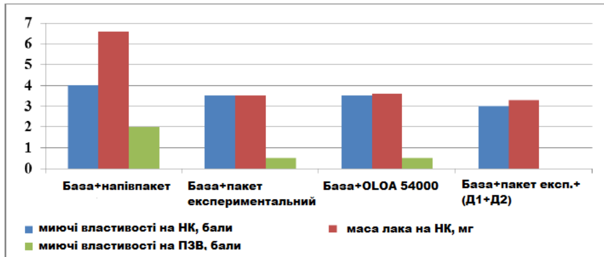
Рисунок 1.4. Вивчення чистильних якостей дослідних зразків за допомогою пристроїв ПЗВ і нахилена улоговина.
