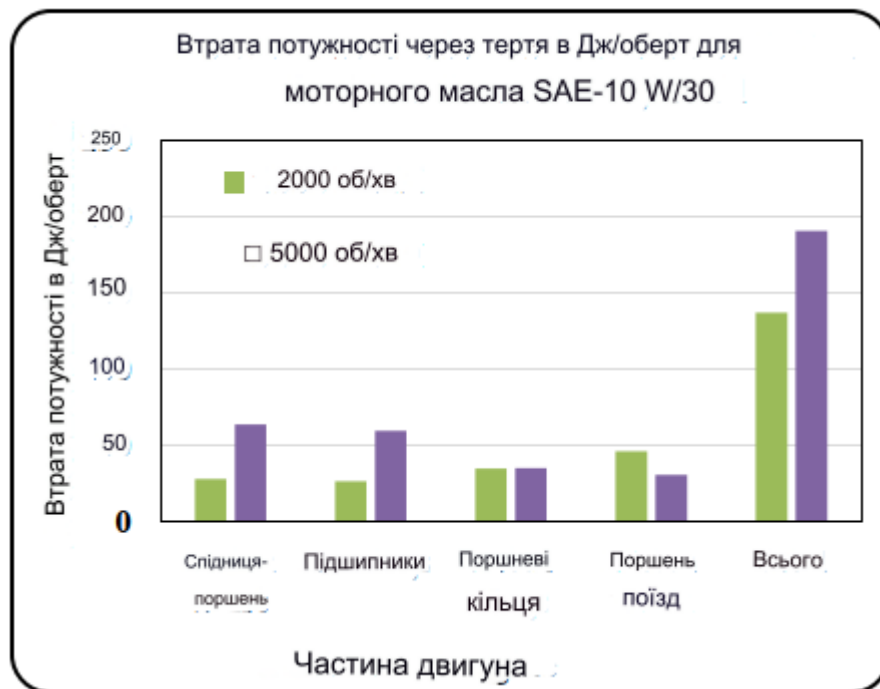
Рисунок 4.3. Результати з програмного забезпечення GM FLARE для бензинового двигуна об'ємом 5,0 літра з моторною олією SAE-10W/30.
