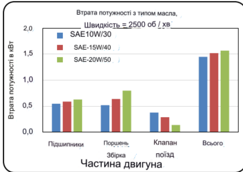
Рисунок 4.5. Результати за моделлю тертя двигуна від Shell для бензинового двигуна Mercedes Benz M111 об'ємом 2,0 літра при 2500 об/хв.
