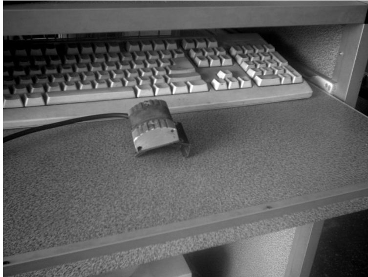
Рис. 4.29. Сенсор вимірювання натиску на гальмівній педалі.
