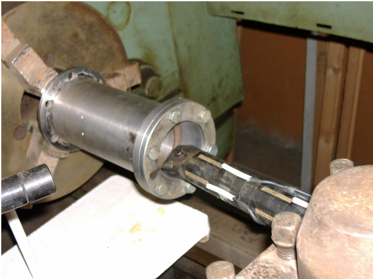
Рисунок 4.5. - Світлина пристрою для проведення процесу розточування
