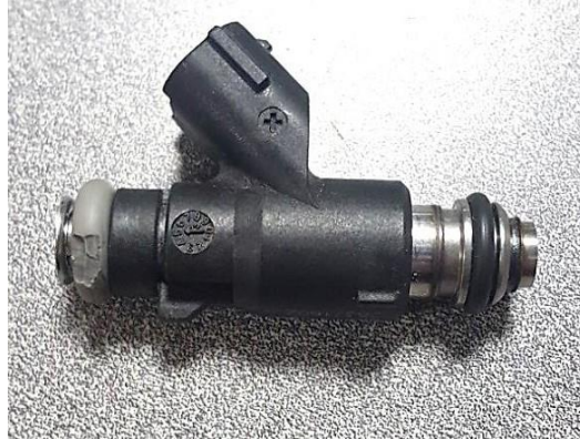
Рис. 3.6. Форсунка для стисненого природного газу Delphi Multec
