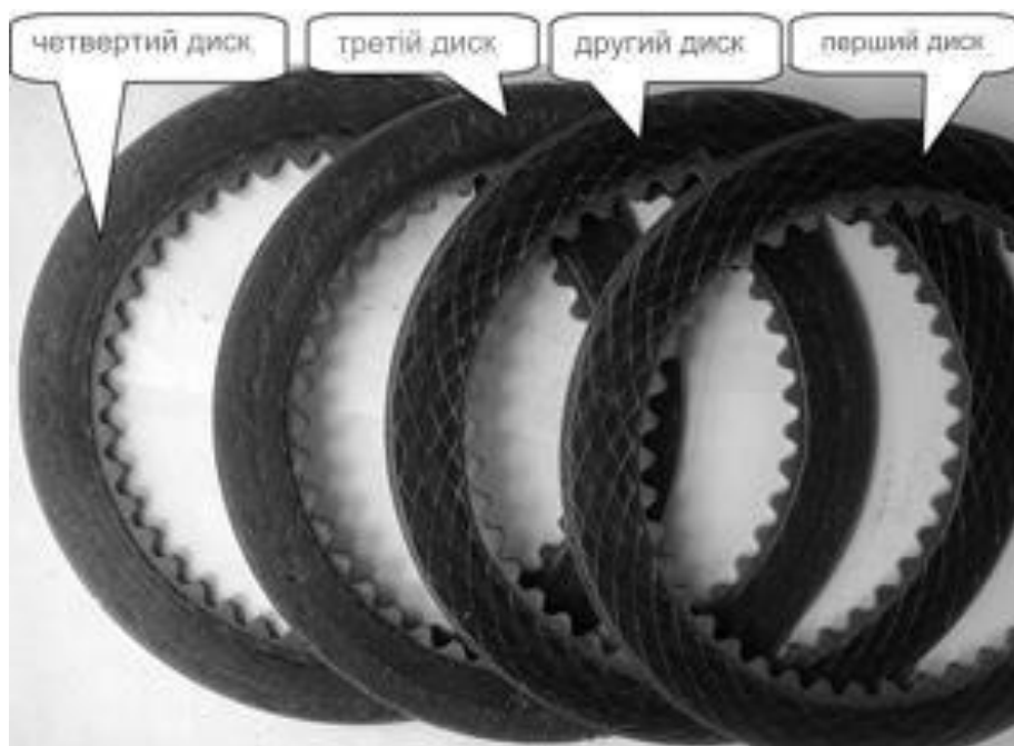
Рис. 4.4. Вигляд фрикційних дисків зчеплювальної муфти з обкладинками з ФМ-15 матеріалу після 20 тисяч циклів активацій/деактивацій.
