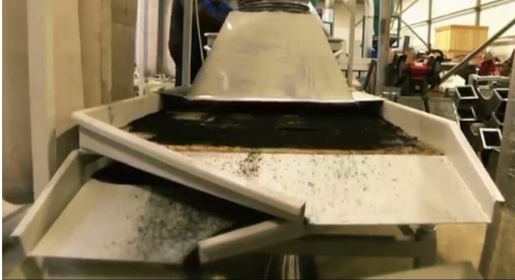
Рис. 2.22. Процес відділення гумової крихти за розміром за допомогою вібросит.
