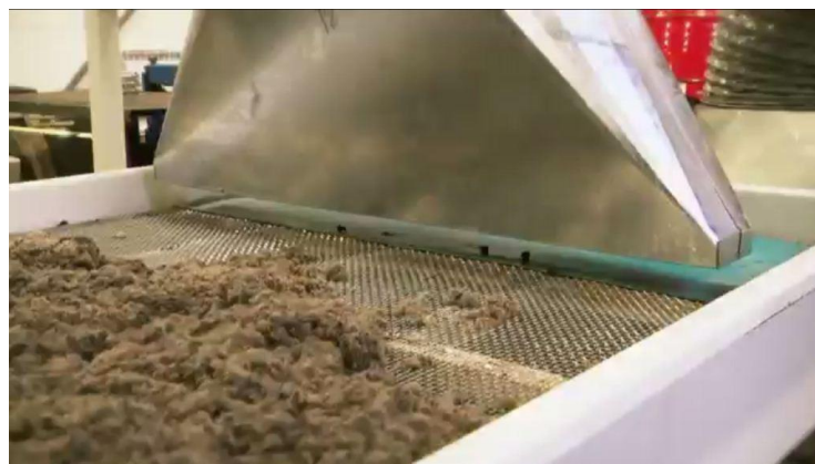
Рис. 2. 21. Процес відокремлення корду текстильного за допомогою вібросита і відокремлення за допомогою тиску повітря
