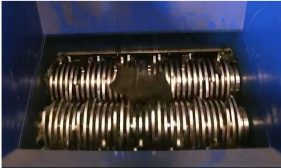
Рис. 2.19. Процес дріблення фрагментів гуми на валкових шредерах для подальшої переробки.
