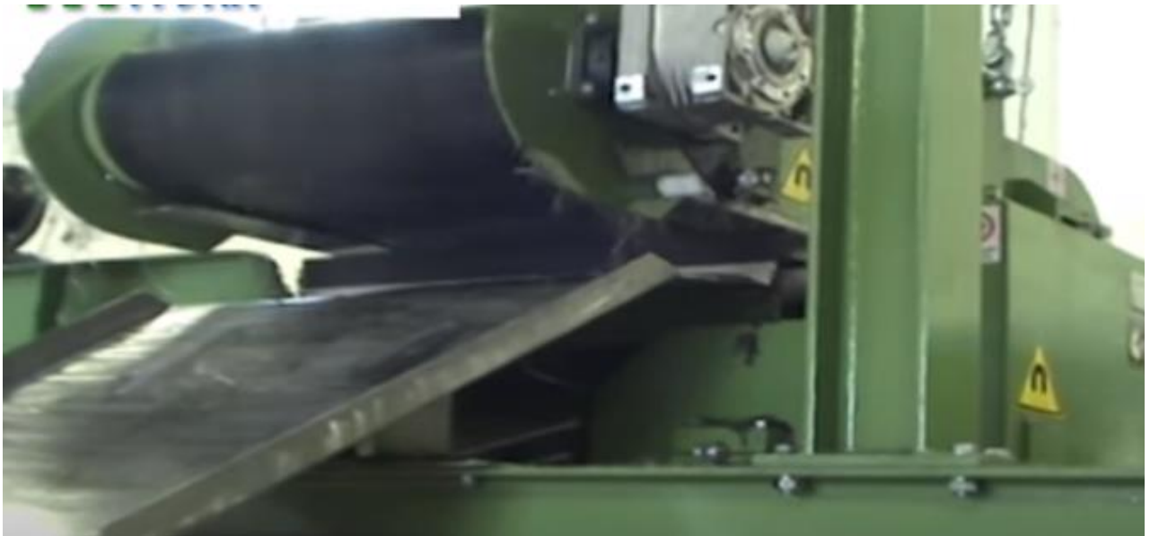
Рис. 2.6. Видобуток великих фрагментів феромагнітних металів після дробіння виведених з експлуатації автомобілів на шредері за допомогою магнітних барабанних сепараторів.
