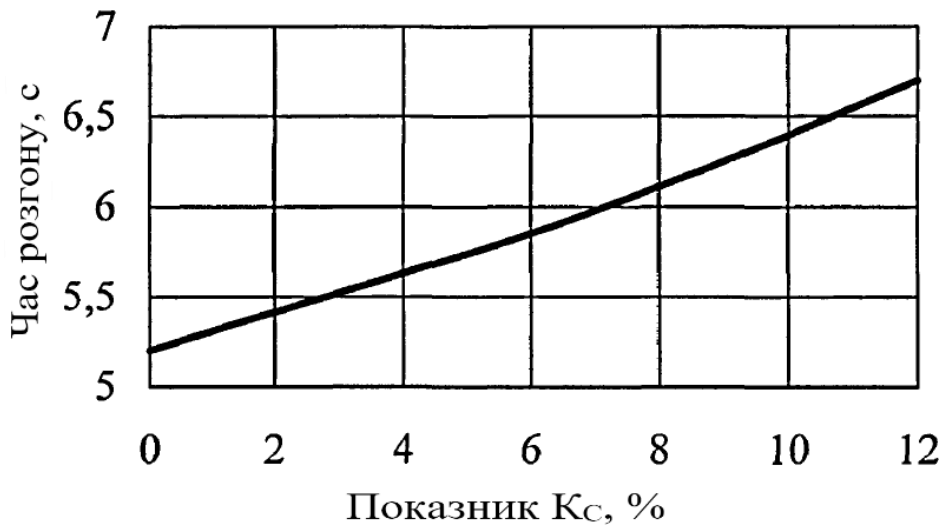
Рис. 2.5. Модельна діаграма впливу забрудненості ЕМФ на час розгону двигуна в діапазоні від 2000 до 5000 об/хв при використанні другої передачі.
