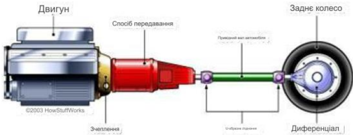
Рис. 1.1. Силовий агрегат передає енергію на привідні механізми коліс.
