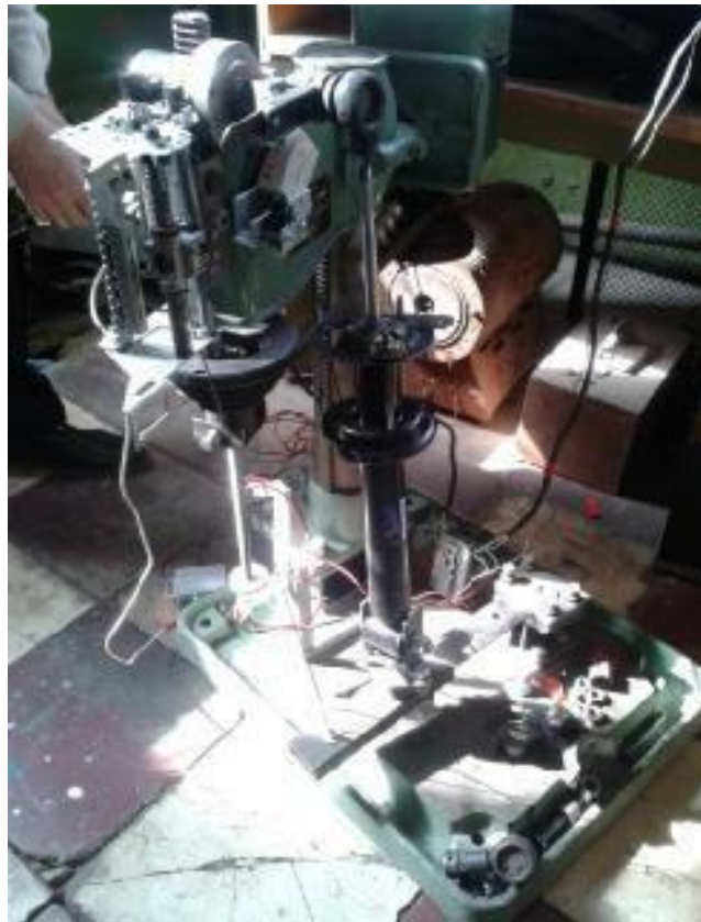
Рис. 3.1. Стенд для вивчення амортизаторів за параметрами стискання та відскоку
