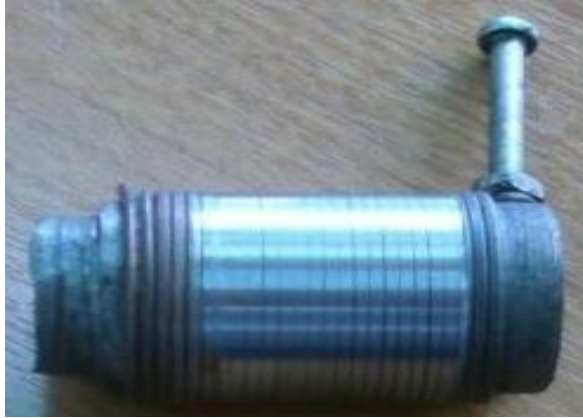
Рис. 4.4. Вкладиш пружини на утримувачі після циліндричного шліфування.
