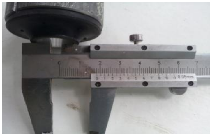
Рис. 4.6. Оброблений внутрішній діаметр алюмінієвої вставки сайлентблока.
