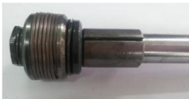
Рис. 4.5. Скомпонований поршень з мідним ущільнювальним пружинним вставним елементом.
