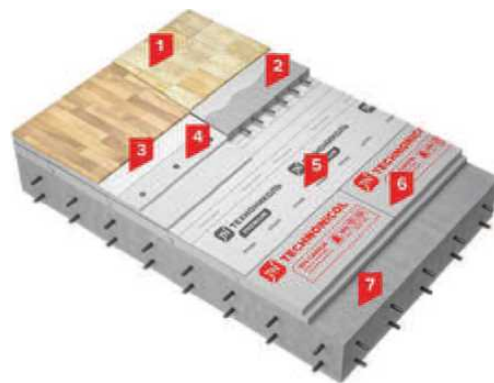
Рисунок 1.6 – Конструкція підлоги консольної частини музею (позначення див. табл. 1.4)
