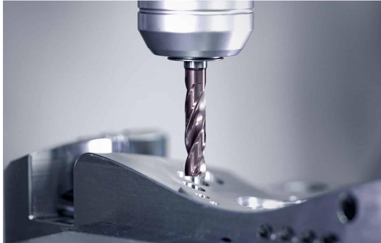
Рисунок 1.5 – Застосування свердла RT 100 FB компанії Gühring для свердління отворів на нахилених і криволінійних поверхнях [21]
