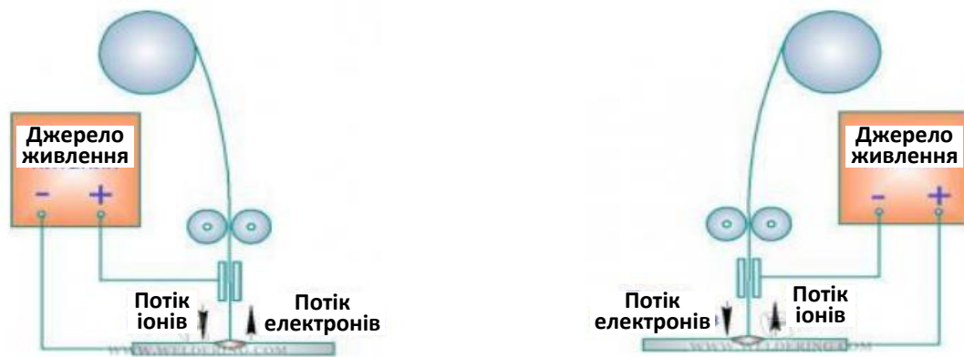
Рисунок 3.8 – Порівняльний аналіз особливостей зварювання у захисних газах на зворотної та на прямій полярності
