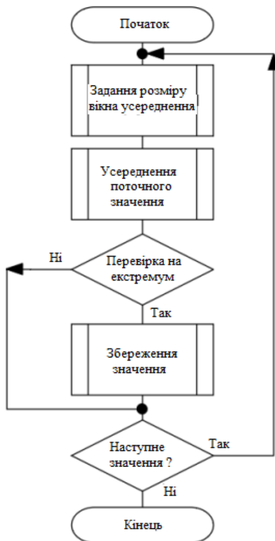
Рисунок 3.3 – Блок-схема алгоритму визначення екстремумів графіка яскравості
